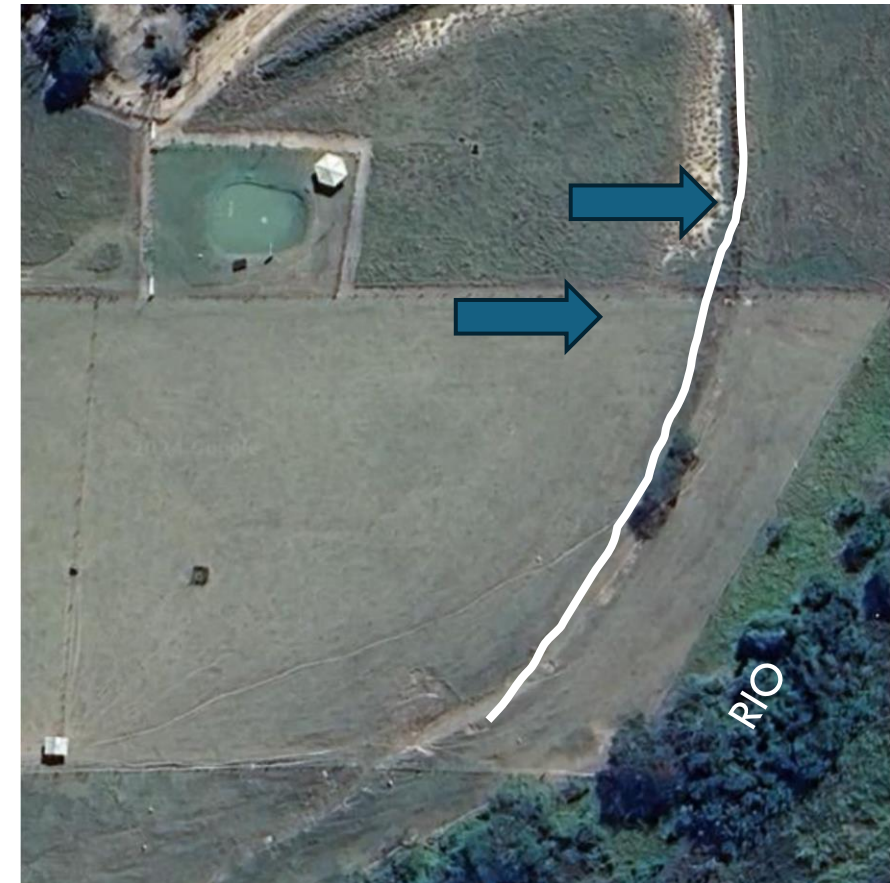
Barreira de superfície para infiltração de água e aumento do fluxo de base do rio
